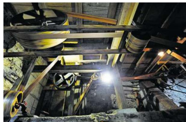
Besonders eindrücklich ist der Antrieb mit den vielen Rädern und Riemen zur Kraftübertragung ab dem Wasserrad zur Säge.
